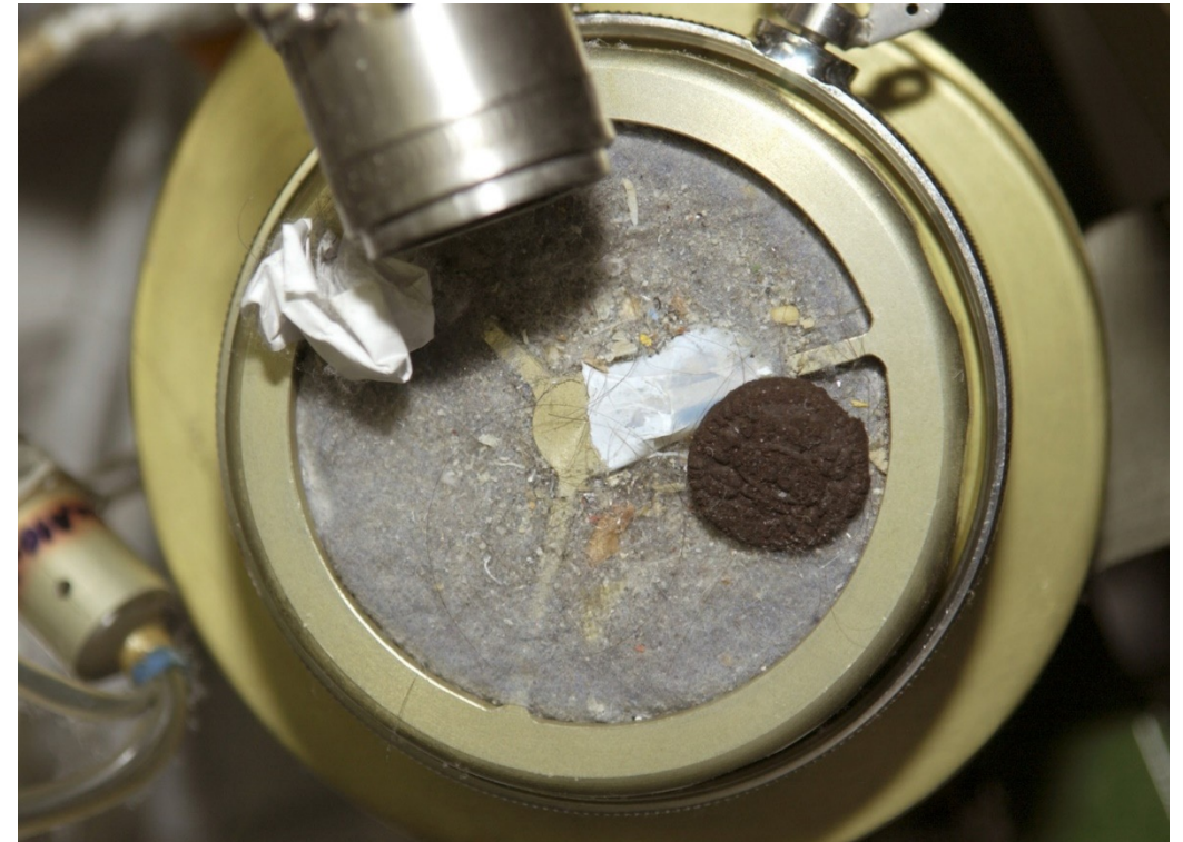
Dirty avionics intake fan
